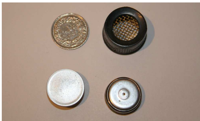
Abbildung 4 Datenlogger i-Wire hygroschrome Oberseite (unten links), Unterseite mit Messmembran (unten rechts), Logger mit Schutzhülle (oben rechts), wie er in die Bienenvölker eingesetzt wurde. Als Grössenvergleich dazu ein 50Rp Stück (oben links).
