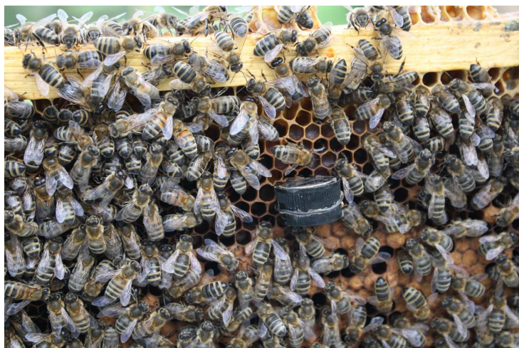
Abbildung 6 Temperaturlogger mit Schutzhülle über der Bienenbrut auf der Brutwabe mit Draht befestigt
